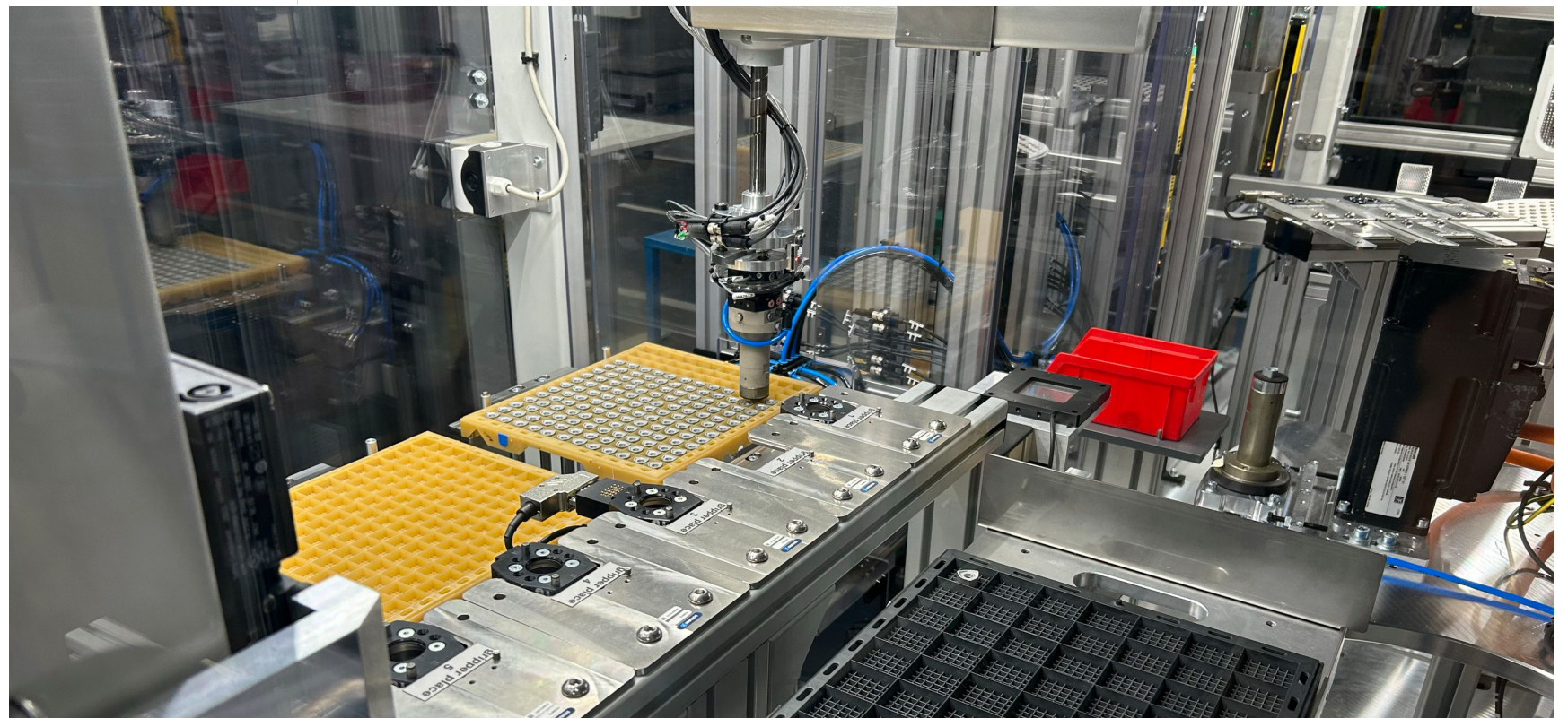
Maskincellens alla funktioner, såsom placering av Seco-skär och skrotning, automatiseras helt genom AI-teknik.
